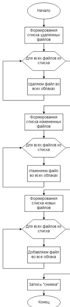
Рис. 3. Алгоритм проверки наличия изменений и их отмены
