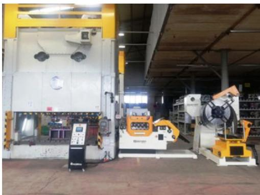
Рис. 4. Правильно-подающая машина SACFORM в составе штамповочной линии
