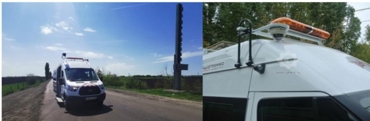
Рис. 2. Внешний вид передвижной дорожной лаборатории «ТРАССА» и установки видеокамеры
