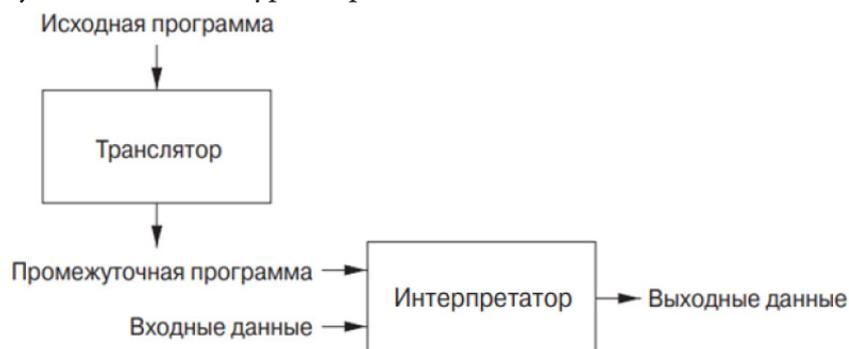
Рис. 4. Гибридный компилятор
