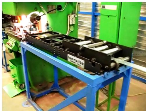
Рис. 5. Правильно-подающее устройство Herrblitz в составе штамповочной линии
