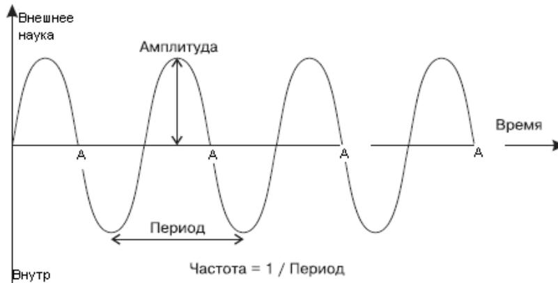
Рис. 1. Простой повторяющийся сигнал, показывающий зависимость амплитуды от времени
