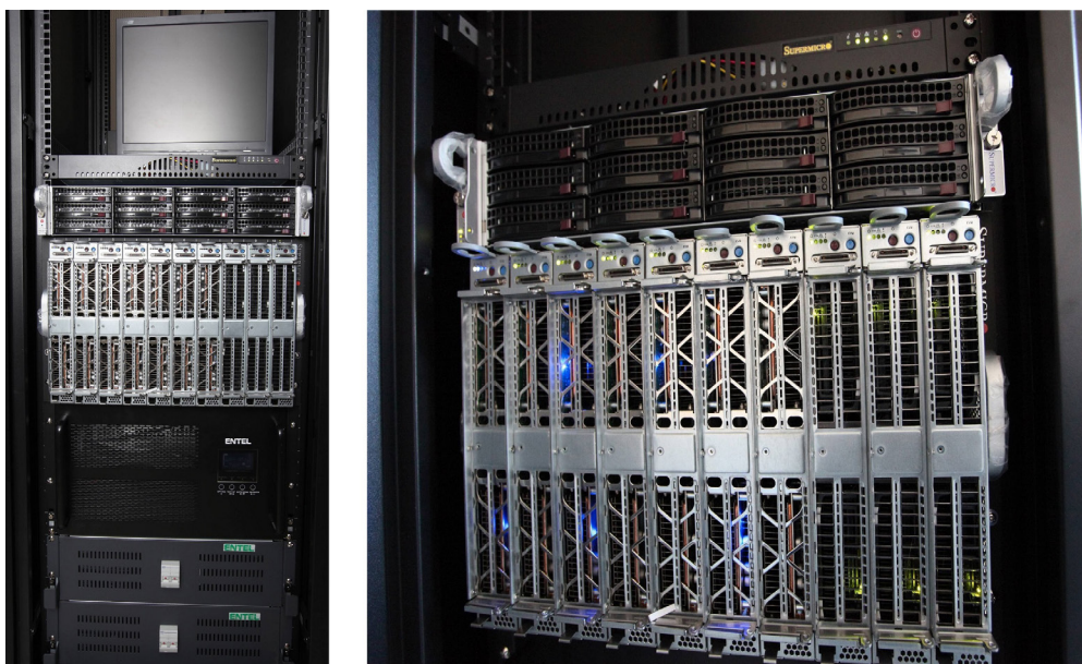
Рис. 3. Внешний вид суперкомпьютера (слева — общий план, справа — детальный вид передней панели)
