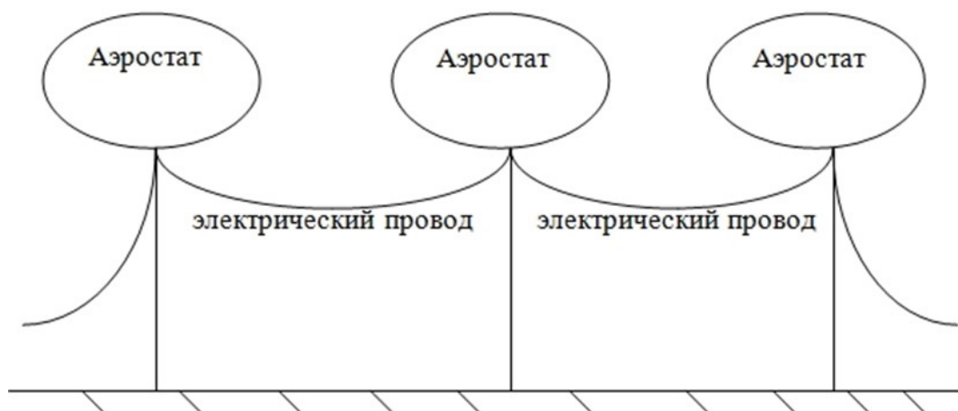
Рис. 1. Схема временной воздушной линии электропередачи
