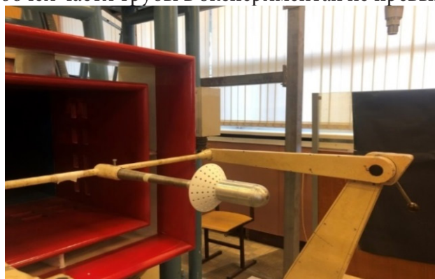
Рис. 2. Экспериментальная модель со сферическим закруглением и перфорированной юбкой в рабочей части аэродинамической трубы
