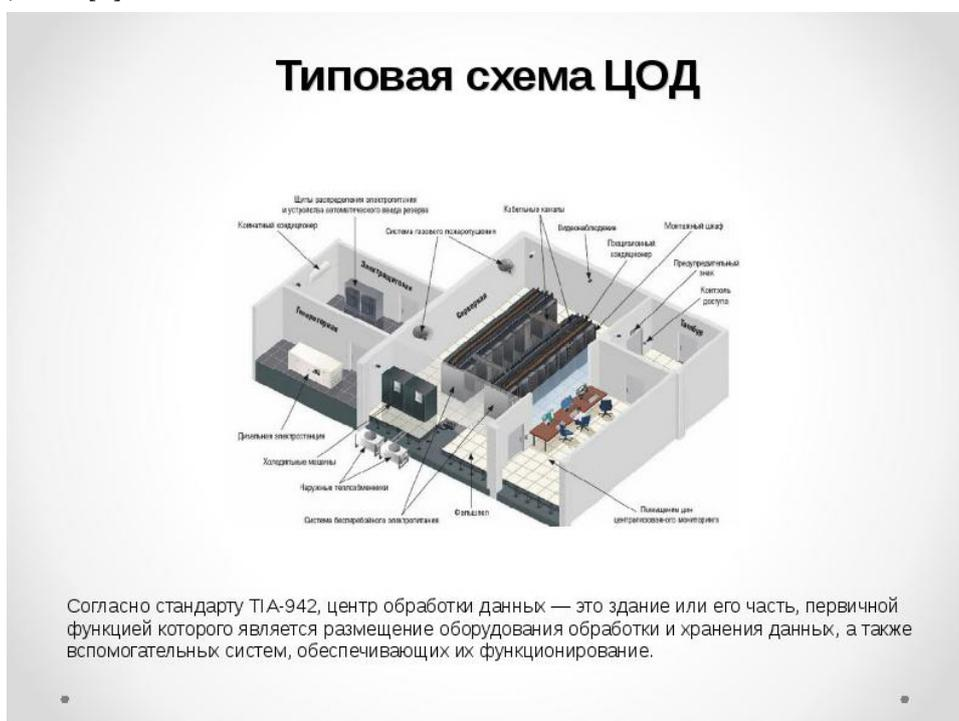
Рис. 1. Типовая схема ЦОД
